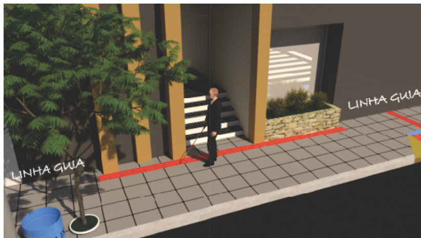
UTILIZANDO AS FACHADAS COMO LINHA-GUIA
