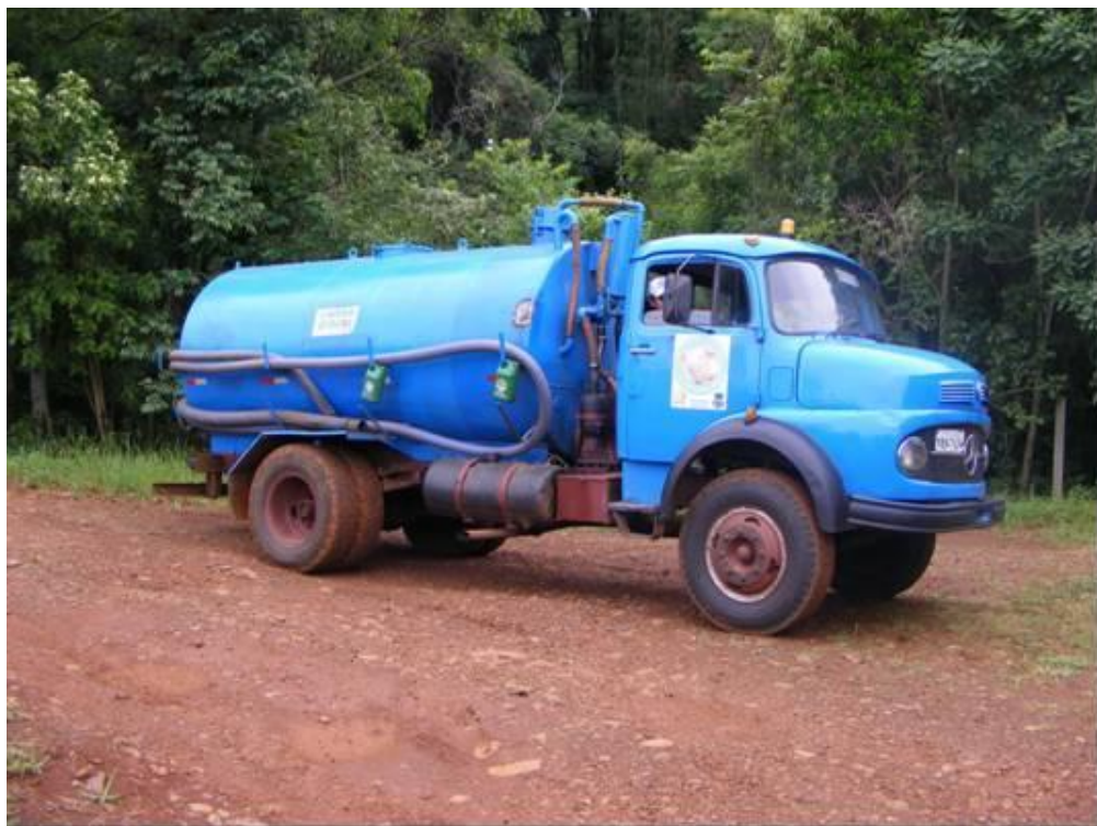
Figura 44: Caminhão limpa-fossa destinado à coleta e descarga do lodo proveniente das residências.
